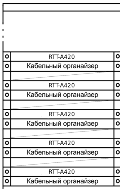
Рис. 26 – Размещение коммутаторов RTT-A420 в стойке
