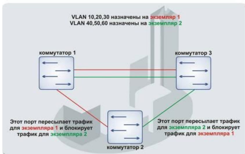
Рисунок А.1 – Настройка протокола множества связующих деревьев
